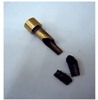
【破損したピンブッシング】
